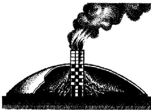
Рисунок 1 – Кучной способ получения кокса
