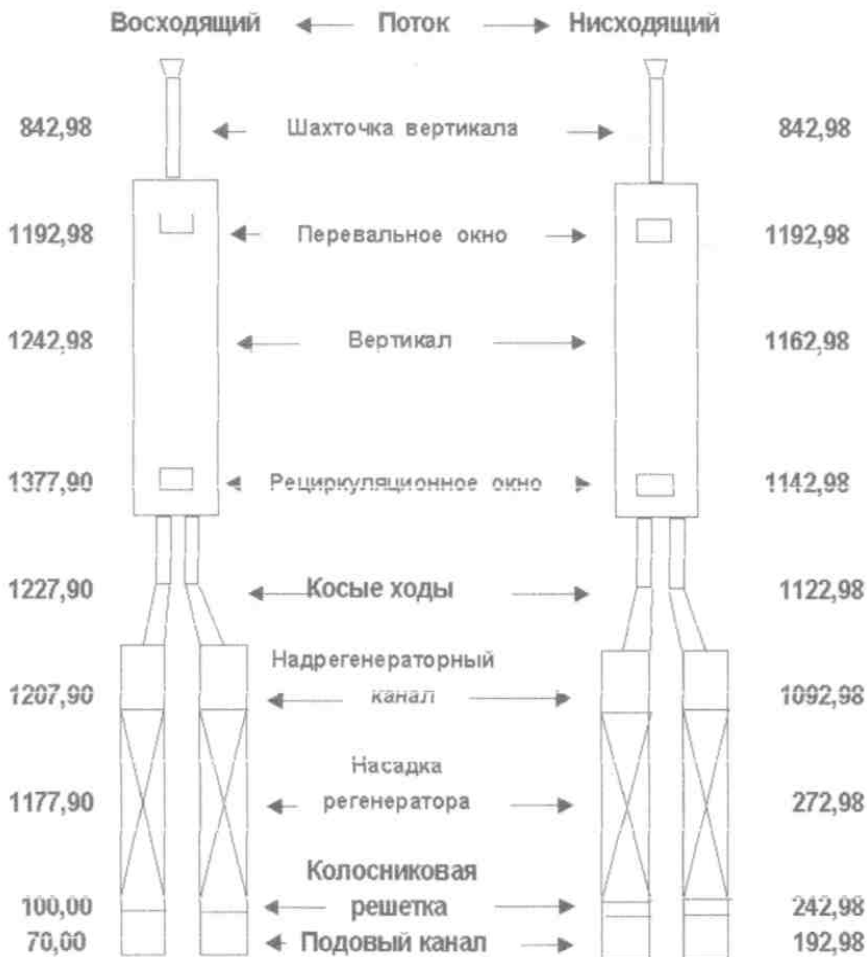
Рисунок 26 – Распределение температур в характерных точках гидравлической системы
